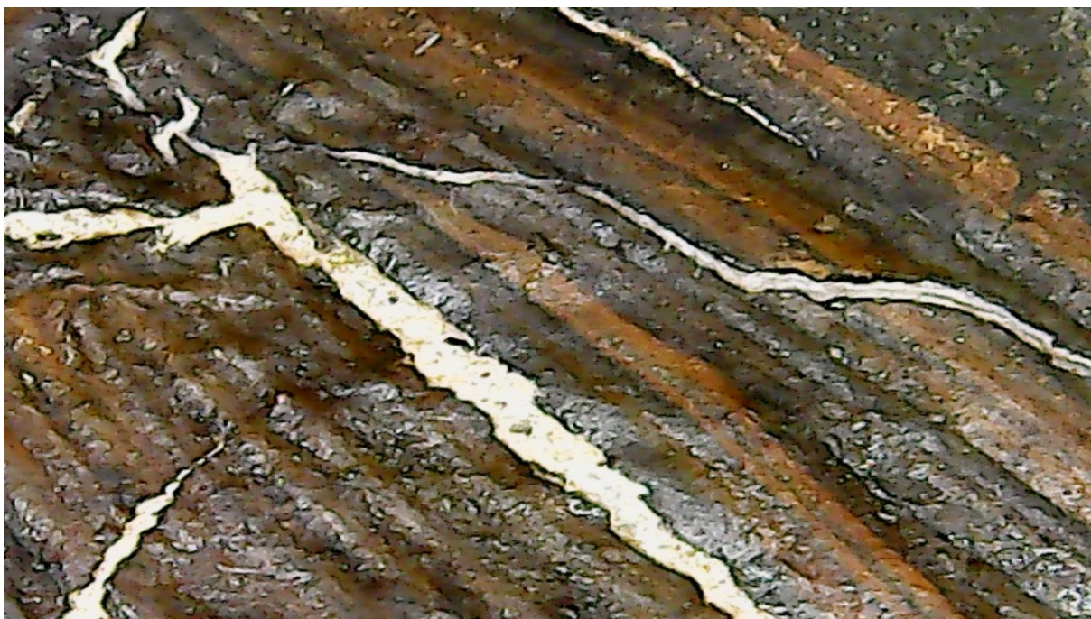
Mély repedések, amelyek a lenolaj öregedésének következményei.
